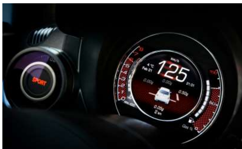
【Gメーター付TFTメータークラスター (画像は欧州仕様)】
